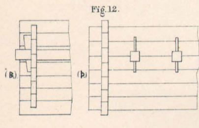
Fig. 12. Bois à assemblage en croix les poutres retenues par des coins. Décarlie.
