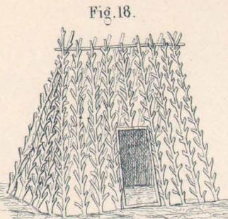
Fig. 18. Etable d'une ferme de tenancier de la paroisse d'Andre, ile de Gotland. La charpente en troncs branchus. La construction couverte de bruyère (*Calluna vulgaris*).
