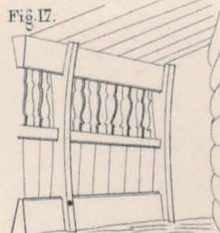
Fig. 17. Construction en poutres verticales avec piliers soubassements et plate-forme Galerie couverte, d'une habitation à Fardal, Fyrisvattnet en Norvège.
