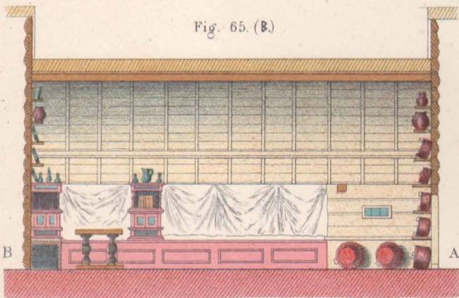
Fig. 65. Habitation à demi-poutres (poutres refendues) à Drahered paroisse de Slättåkra Halland Plan et 4 coupes Voir en outre Pl. XV. Fig. 13.
