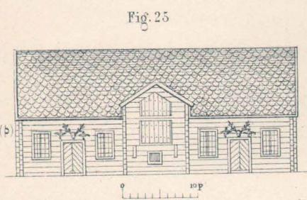
Fig. 25. Ecurie, à Skafringe, paroisse d'Ätvid, Ostrogothie, couverte en bardeaux.
