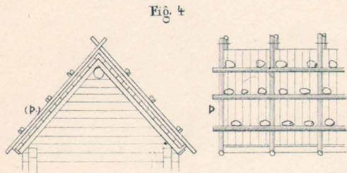
Fig. 4 Toits couverts d'une couche horizontale et d'une couche verticale de planches toutes deux surmontées de cavaliers avec fâitages transversaux et pierres.
