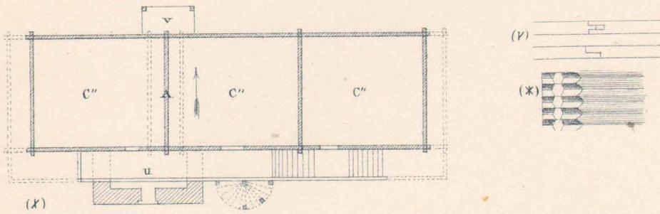
Fig. 21 Edifice à galerie à Ornäs paroisse de Thorsång, Dalécarlie. Perspective de l'intérieur de la galerie, V, X, assemblage des poutres, extrémités entrecroisées de ces dernières (1480)
