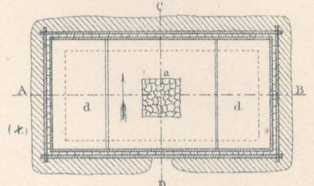
Fig. 43. édifice dit à coupe, de la paroisse de Hede dans le Herjedal, d. Banc-lit, a. Foyer, e. issue pour la fumée.
