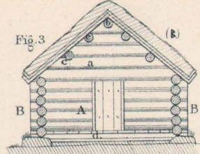
Fig. 3. Coupe d'une habitation dite à faitage et demi faitage en bois ronds avec chevilles. A, pignon, a. faite, b. faitage; c. pannes; B, parois en bois ronds, d. plancher avec ses solives.— Fig. 4. Coupe d'une habitation à chevrons (sans pannes), (ancienne forme) a. le faitage, b. les chevrons.— Fig. 5. Toiture d'une grande étable Scanie, a. Chevrons, b. entrails; c. plates formes, d. poutres, e. poteaux
