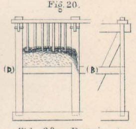
Fig. 20. Parois à pieux recouverts de couches d'argile jaune, fixée au moyen de liens de paille (a) Village d'Ingelstrade paroisse de Väsby, Scanie.
