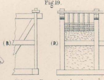
Fig. 19. Parois à pieux et perches, enduite d'argile bleue prise d'une fosse voisine et pressée dans la paroi à coups de maillet Village de pêcheurs de Lerberget paroisse de Väsby, Scanie.
