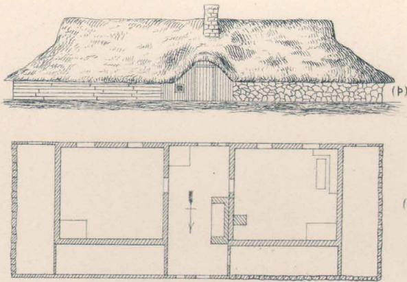
Fig. 38. Habitation avec galerie extérieure couverte, à Jaæderen en Norvège.
