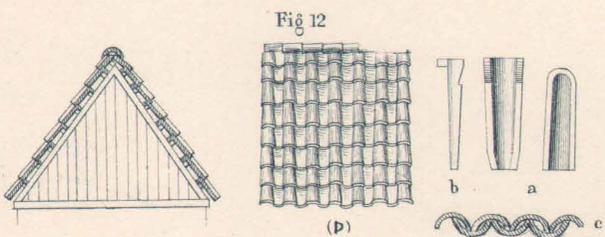
Fig. 12 Toits couverts de tuile bombée. Eglise près de Vadstena, a, côté inférieur de la tuile, b, côté supérieur, c, coupe
