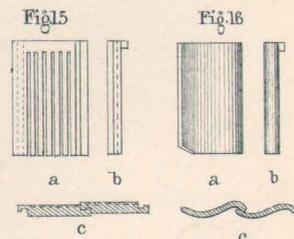
Fig. 15 Tuiles plates avec stries au côté antérieur, et coulisses sur les bords à Stockholm. La tuile date du 18<sup>me</sup> siècle
