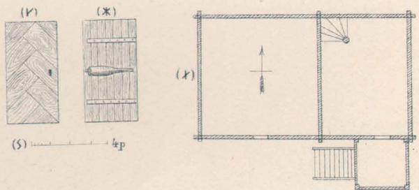
Fig. 26 Grenier du domaine d'Eka paroisse de Lillkyrka Upland. (1410) V, Assemblage des bois ronds, V, la partie extérieure, et X la partie intérieure de la porte avec serrure en bois
