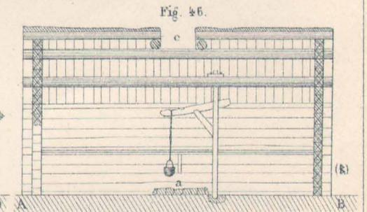
Fig. 46. Edifice à foyer (cuisine d'été) édifice à coupe, paroisse de Tennäs Herjedal, a. Foyer, b. four, e. banc, d. banc-lit, g. table, e. lit ordinaire
