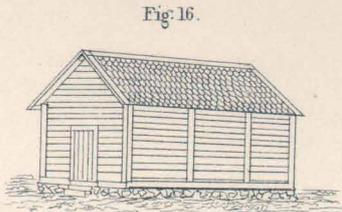
Fig. 16. Séchoir sans foyer, avec interstices pour l'air, entre les planches des parois, domaine de Raumnäs, en Vestmanland
