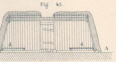
Fig. 43. édifice dit à coupe, de la paroisse de Hede dans le Herjedal, d. Banc-lit, a. Foyer, e. issue pour la fumée.
