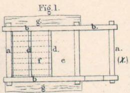
Fig. 1. Plan d'une vieille habitation basse à bois ronds sans chevilles, a. Soubassements b. racinaux d. solives, e. plancher en terre battue, f. id. en planches g. banc construit en dehors.— Fig. 2. Long côté de la même habitation a. Soubassement, b. racinaux et leurs pierres d'appui, c. bois ronds des parois d. plate-forme.
