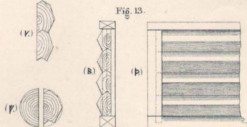
Fig. 13. Poutres refendues Village et paroisse de Väsby Scanie P, partie extérieure de la paroi, B, coupe P, le bois refendu; V, le demi bois équarri et assemblé.
