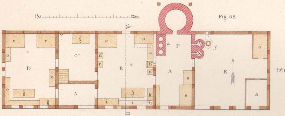
Fig. 68. Habitation en clayonnage du village et paroisse d'Espö Scanie
