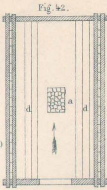
Fig. 42. Edifice dit à coupe la moitié enfoncé dans la terre Jemtland Montre les sous-faîtages (pannes) extérieurs et intérieurs primitifs
