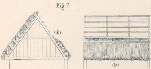
Fig. 7 Toits couverts de junc de scirpe ou de paille de seigle peignée Scanie.
