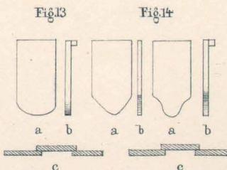
Fig. 13 Toits couverts en tuile plate Hangar du presbytère d'Osno, Södertörn (Sudermanie) a, côté antérieur, b, profil, c, coupe
