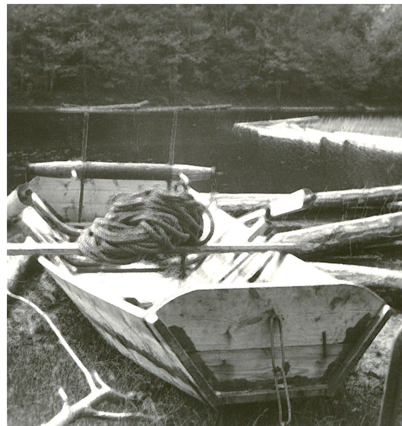
Flottningsbåt (”spelebåt”) med spelverk i Nissafors vid Nissan. Källeryds socken i Småland. Foto Gunnar Hobroh 1936. På akterspegelns mitt syns kroken där båten fästes med en kedja vid timmerflotten. Repet i båten var 100 meter långt men sattes samman till längder av 400-500 meter. Luf, B 7876.
